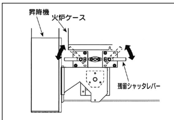
④ 樋開閉レバーを動かして残留穀物を落としてください。
