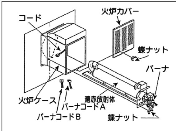
③ 放射体を固定している蝶ナット（M6-2個）、バーナコードおよび高温サーモのコードをはずしてください。
