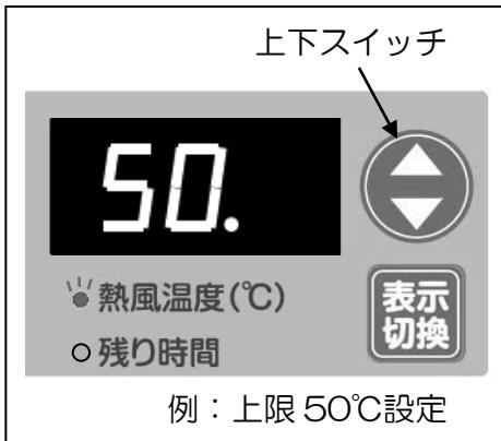
ダイヤルから手を離して数秒待つと、熱風温度ランプが点滅して、上限温度設定画面に切り換わります。上下スイッチでお好みの上限温度を選択します。
