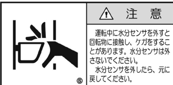
運転中に水分センサを外すと回転物に接触し、ケガをすることがあります。水分センサは外さないでください。
