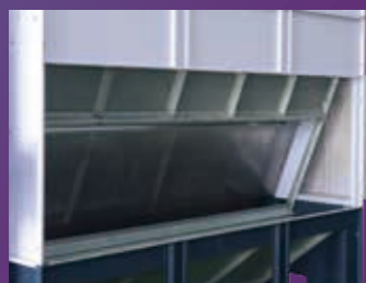
さらに風胴を外した状態
