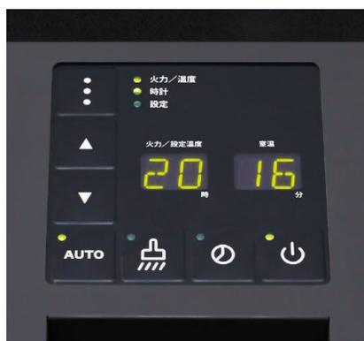
当社としては初めて、設定した室温にあわせて火力を自動で調整する「AUTO運転モード」を搭載。燃焼後の灰を簡単にお手入れしやすい構造、そして初めての方でも安心してお使いいただけるよう、従来の木質ペレットストーブからあった安全装置に加え、燃焼室扉・タンクフタの開閉検知装置、灰詰まり検出装置、誤使用を防止するロストルクリーニングお知らせ機能を搭載しました。
