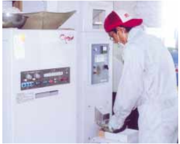
弊社製RM-370を使用した精米作業。
